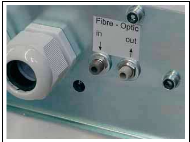
Připoje světlovodičů (technika FSMA)
