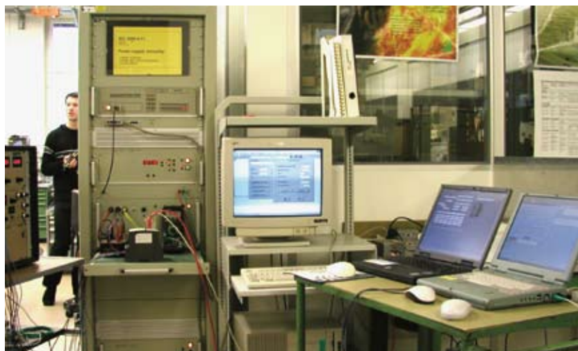
Měření chování přístrojů při poklesech napětí, krátkodobých přerušeních a kolísání napětí pomocného napájení
