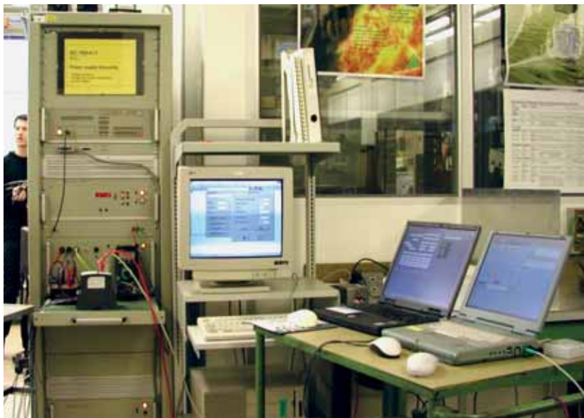
Měření chování přístrojů při poklesech napětí, krátkodobých přerušeních a kolísání napětí pomocného napájení
