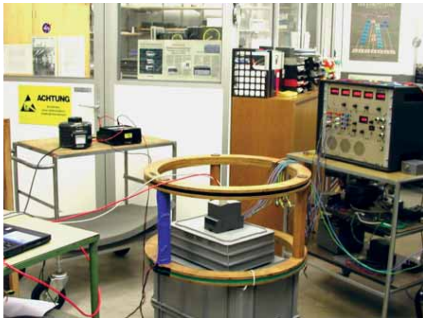
Zjišťování chování přístrojů vystavených vlivu magnetického pole vytvářeného pomocí Helmholtzovy cívky
