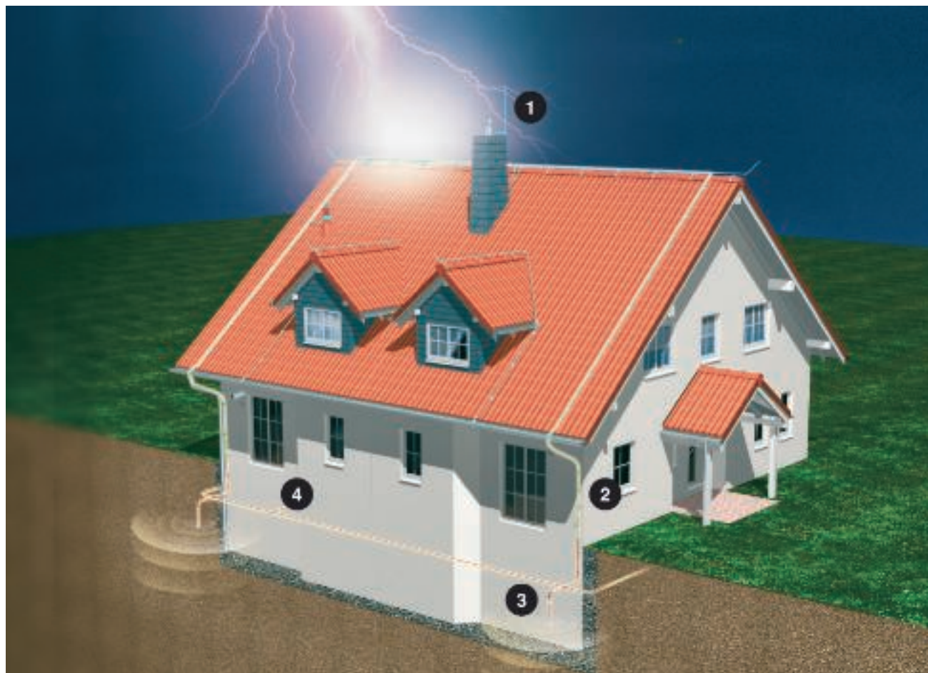
1 = jímací zařízení, 2 = svod, 3 = uzemňovací systém, 4 = vyrovnání potenciálů
