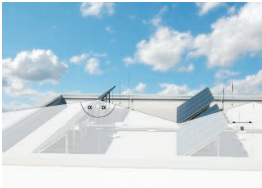
Obr. 2: \alpha^\circ = úhel ochrany před bleskem
