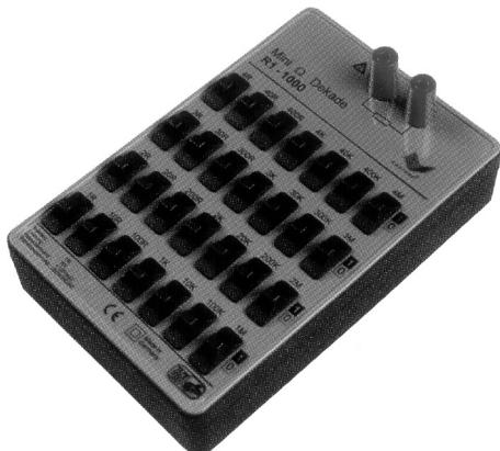
Odporové dekády řady R1-1000SAB a R1-3000SAB s možností nastavení odporů v rozsahu od 1Ohm do 11,111MΩ a krokem 1Ohm mají přesnost 1%. Jednotlivé hodnoty jsou nastaveny samostatnými přepínači.
