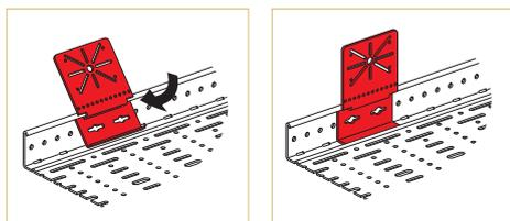
Upevnenie na bočnú stenu, bez skrutiek pomocou zaklapnutia
