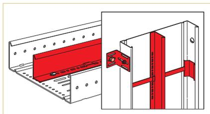
(1) Pre montáž na neperforovaný káblový žlab je nutné vyvrátať montážne otvory Ø 7 mm
