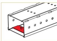
Používa sa na upevnenie krytu, iba pre žľaby šírky 70 mm
