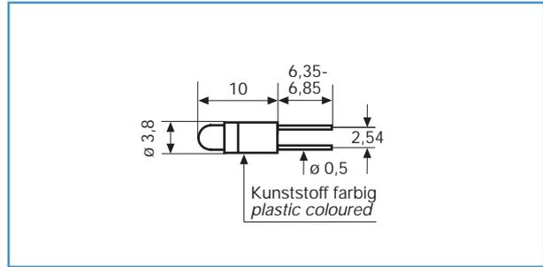
Achtung: Bei den weißen Typen Länge bis zu 11mm / FYA: OAL of the white LEDs up to 11mm
