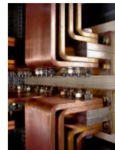
Pripojenie štyroch prípojnic 100x10 mm na každú svorku výsuvného vyhotovenia DMX 4 000.
